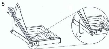
При многократном опускании и поднятии ножа, крепление рукоятки может быть ослаблено. В этом случае закрепите рукоятку с помощью шестигранного ключа.
